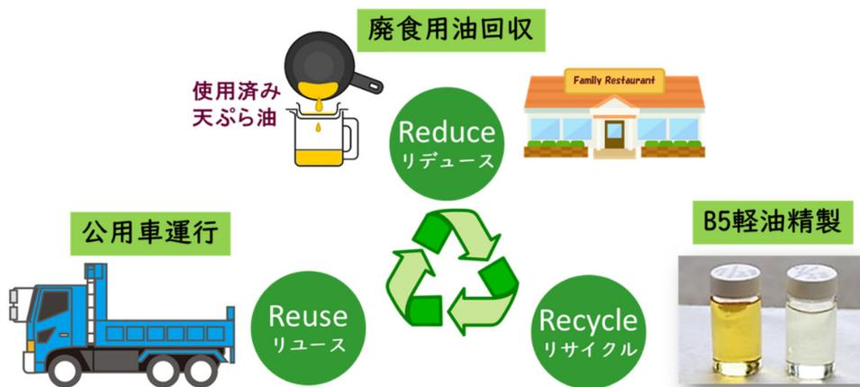
※1 バイオディーゼル燃料は、軽油の代替燃料としてディーゼルエンジン車でそのまま使用することが可能です。排気ガス中の黒煙が軽油より大幅に少なく、酸性雨の原因となる硫黄化合物（SOx）の排出量がほぼゼロであることが特徴です。さらに植物由来燃料としてカーボンニュートラルとされ、CO<sub>2</sub>の排出量を抑制できるため、クリーンな燃料と位置づけられています。
